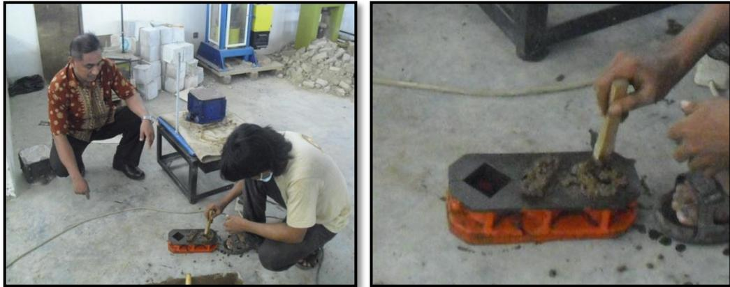
Gambar 4. Pencampuran mortar semen Pasir Lokal Dari Kam. Salor Kab. Merauke
