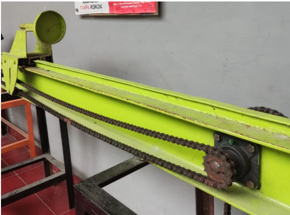
Gambar 2. Sistem penggerak mesin pembelah bambu
