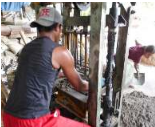
Gambar 4. Proses pencetakan adonan batako beton (Sumber: hasil dokumentasi, 2016)
