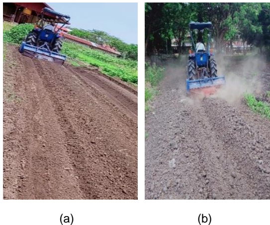
Gambar 4. Pengujian alat pembuat bedengan pada dua tipe lahan : (a) lahan berpasir; (b) lahan berlempung
