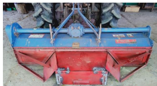
Gambar 2. Alat pembuat bedengan yang digandengkan pada traktor roda 4
