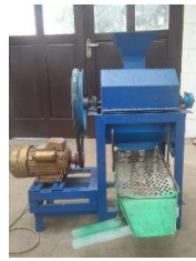
Gambar 2. Mesin mini pengupas kulit kacang tanah setelah di modifikasi
