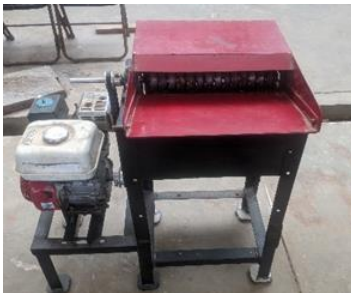
Gambar 2. Mesin pamarut sagu
