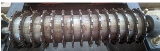
Gambar 3. Bentuk roller dengan mata parut rantai chain saw .
