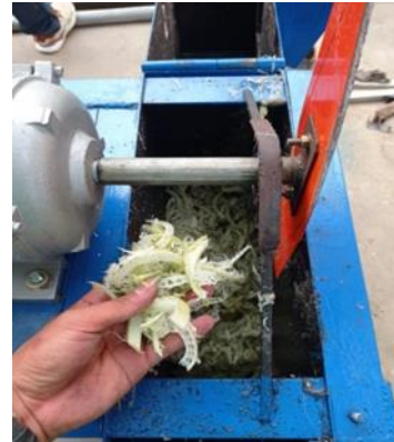
Gambar 3. Letak mata pisau pada alat pemotong pakan ternak babi
