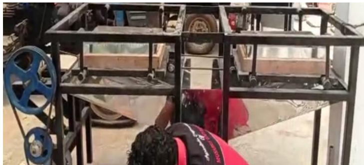
Gambar 5. Uji fungsi mesin pengayak pati sagu
