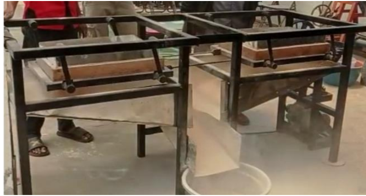
Gambar 6. Uji kerja mesin pengayak pati sagu
