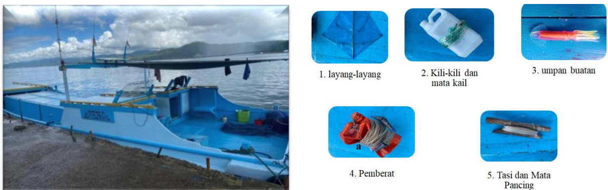
Gambar 2. Kapal Pancing Tonda sementara berlabuh di PPN Ambon (a), konstruksi unit pancing tonda yang digunakan nelayan (b).
