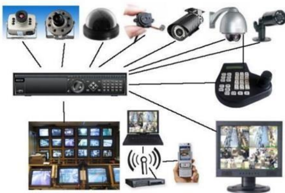
Gambar 17 Sistem instalasi CCTV
