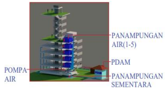
Gambar 25. Instalasi Air Bersih
