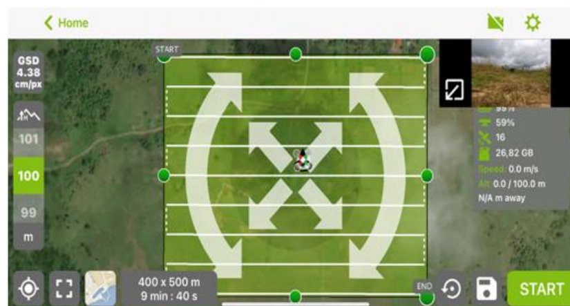
Gambar 3. Perencanaan desain jalur terbang pada software pix4D Capture
