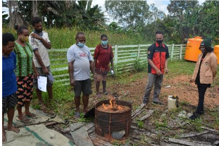
Gambar 4. Pengarangan limbah padat sagu menggunakan drum.
