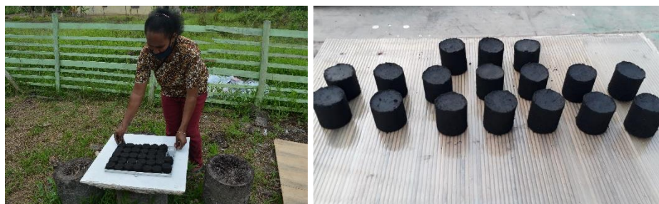
Gambar 7. Penjemuran briket (kiri) dan produk briket arang limbah padat sagu hasil pelatihan oleh mitra (kanan)
