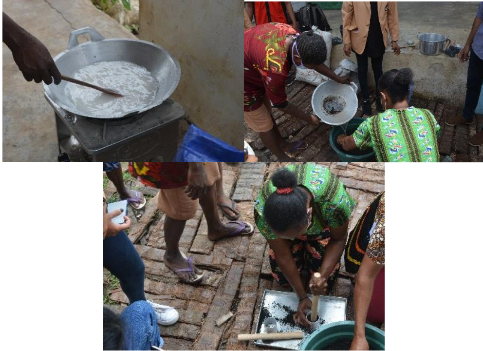
Gambar 6. Pembuatan perekat briket (kiri), adonan campuran perekat dan bubuk arang (tengah), pencetakan briket (kanan).
