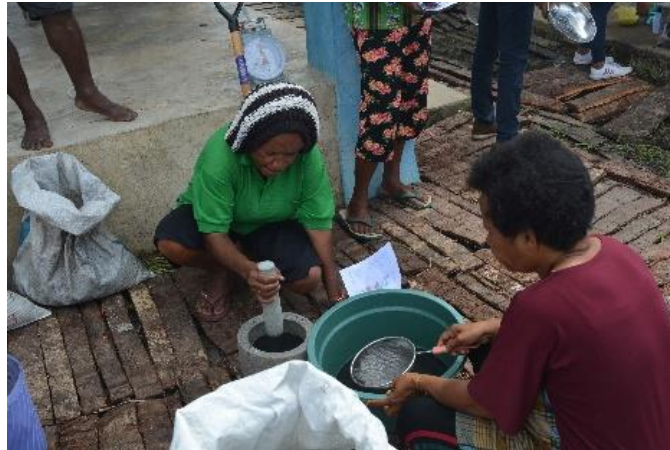
Gambar 5. Pengecilan ukuran dengan lesung dan pengayakan.
