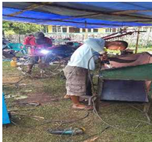
Gambar 7. Penggantian sparepart dan pengelasan Perontok Padi
