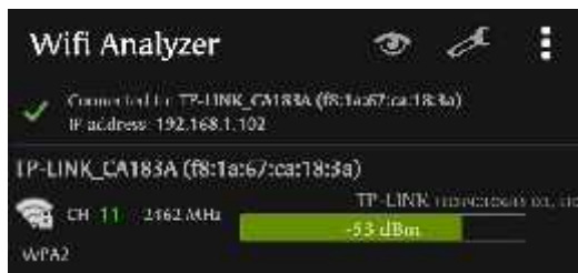
Gambar 12 (b) Pengukuran Antena yagi menggunakan wifi analyzer untuk kondisi Los dengan jarak 5 meter dari access point
