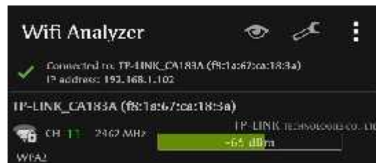
Gambar 13 (b) Pengukuran Antena yagi menggunakan wifi analyzer untuk
