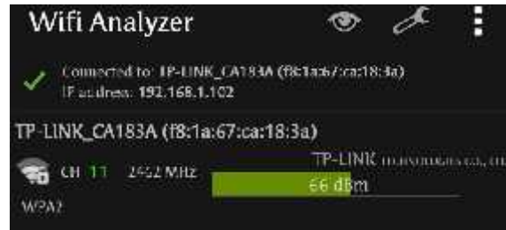
Gambar 13 (a) Pengukuran Antena yagi menggunakan wifi analyzer untuk kondisi Non LOS dengan jarak 5 meter dari access point.
