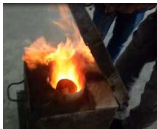
Gambar 3. Proses pengoperasian tungku peleburan Aluminium
