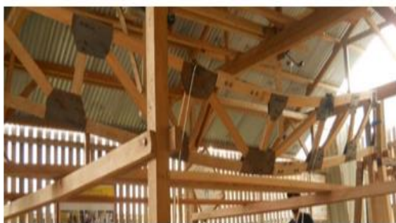
Gambar 4. Bentuk kegagalan konstruksi rangka batang hasil pengujian
