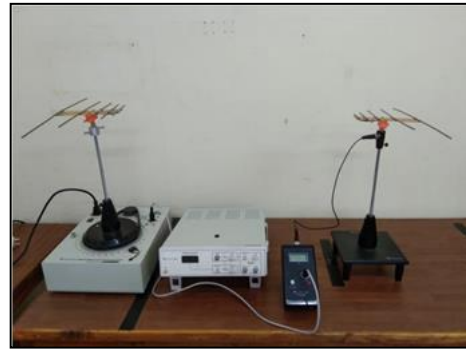
Gambar 2. Pengujian antena menggunakan Trainer antena scientech 2261
