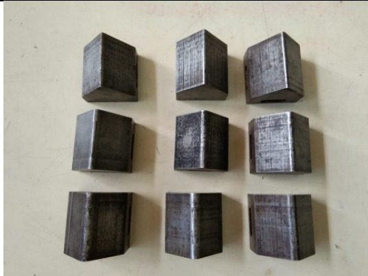
Gambar 4. Variasi Sudut dan Radius Punch
