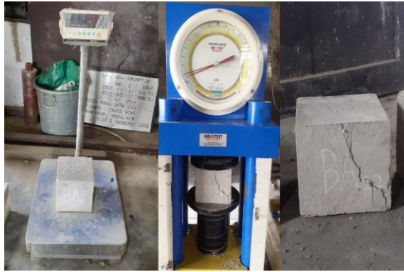
Gambar 5. Pengujian kuat tekan beton
