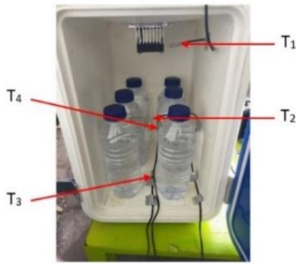
Gambar 3. Posisi penempatan sensor termokopel di dalam kotak pendingin
