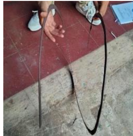
Gambar 5. Profil helical ribbon hasil pengerolan
