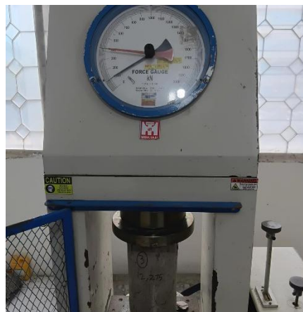
Gbr. 3. Pengujian Kuat Tekan Beton
