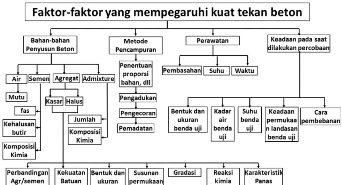
Gambar 4 Faktor-faktor yang mempengaruhi kekuatan beton
